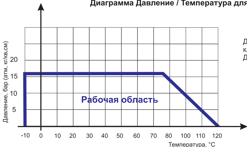
Диаграмма Давление / Температура для клапана обратного ABRA-D-122
